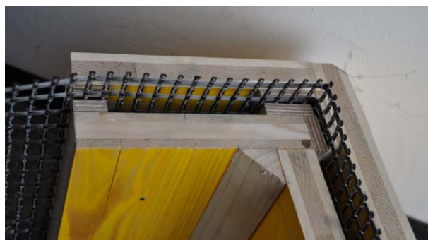
Abbildung 6 Schalung eines Versuchskörpers mit zentrischem CFK-Gitter
